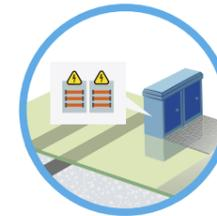
**Linkboxen**, um die Fehlersuche zu beschleunigen und Kabelmessungen durchzuführen.
