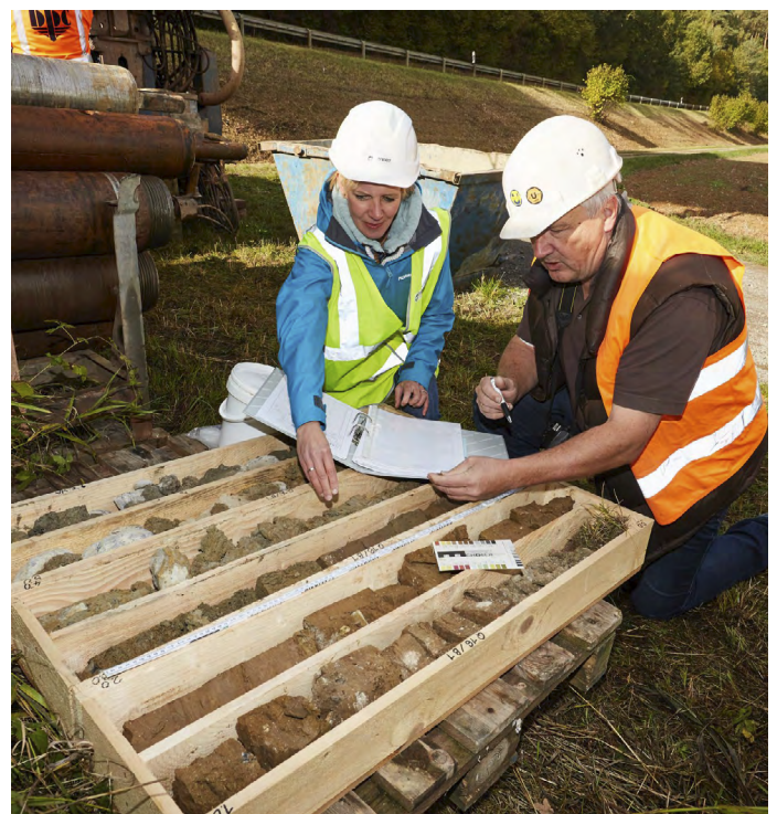
Im Rahmen von Baugrunduntersuchungen werden örtliche Bodenverhältnisse untersucht, um die geeignetste Bauausführung zu bestimmen.
