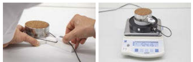
Regal um Regal: Die Bodenproben werden in Steckzylindern auf Waagen verteilt.
