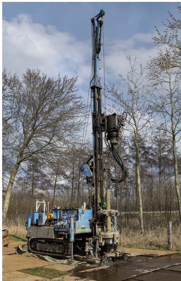
Kettenfahrzeug mit Rotationskernbohrer Länge 5 m | Breite 2,30 m | Gewicht ca. 20 t | Bohrtiefe bis 30 m
