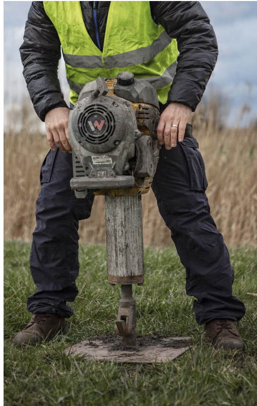
Handbohrgerät Gewicht bis 25 kg Bohrloch-Durchmesser bis 80 mm Bohrtiefe bis 5 m
