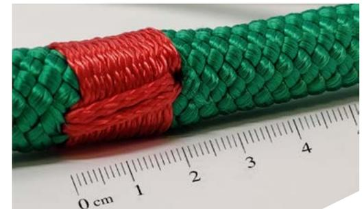
Der Kern des Windenseils wird im Betrieb durch einen Takling in der Signalfarbe Rot geschützt
