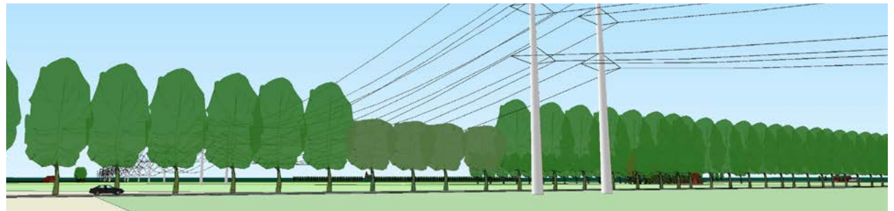
Figuur 53b. Onderbreking van een laanbeplanting bij kruising van een hoogspanningsverbinding. De lijn kruist de laan vlak bij een mast, onder de lijn kunnen de bomen blijven gehandhaafd maar moeten worden gesnoeid
