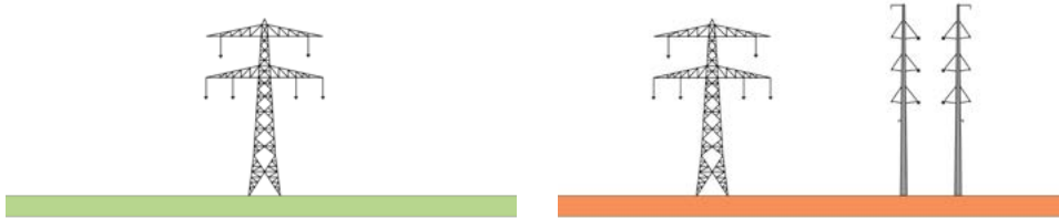
Figuur 66.f Als een 2 x 380 kV-vakwerkverbinding wordt gebundeld met Wintrack 2 x 150 kV + 2 x 380 kV: forser
