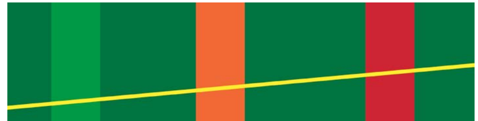
Figuur 15. Het traceringsprincipe van een hoogspanningslijn: Autonoom tracé, onafhankelijk van patronen en karakteristieken van het landschap op een lager schaalniveau;
