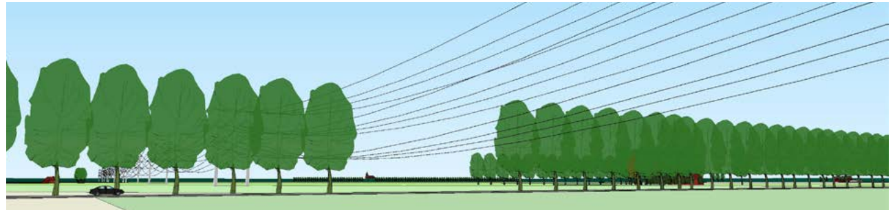
Figuur 53a. Onderbreking van een laanbeplanting bij kruising van een hoogspanningsverbinding. De lijn kruist de laan halverwege twee masten, waar de geleiders laag hangen
