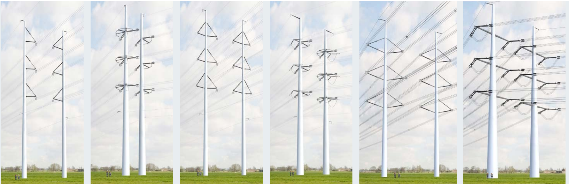
Figuur 14. Wintrack mastenfamilie. vlnr: 2 x 380 kV steunmast en hoekmast, 2 x 380 kV + 2 x 150 kV steunmast en hoekmast 4 x 380 kV steunmast en hoekmast
