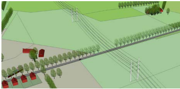
Figuur 53a. Onderbreking van een laanbeplanting bij kruising van een hoogspanningsverbinding. De lijn kruist de laan halverwege twee masten, waar de geleiders laag hangen
