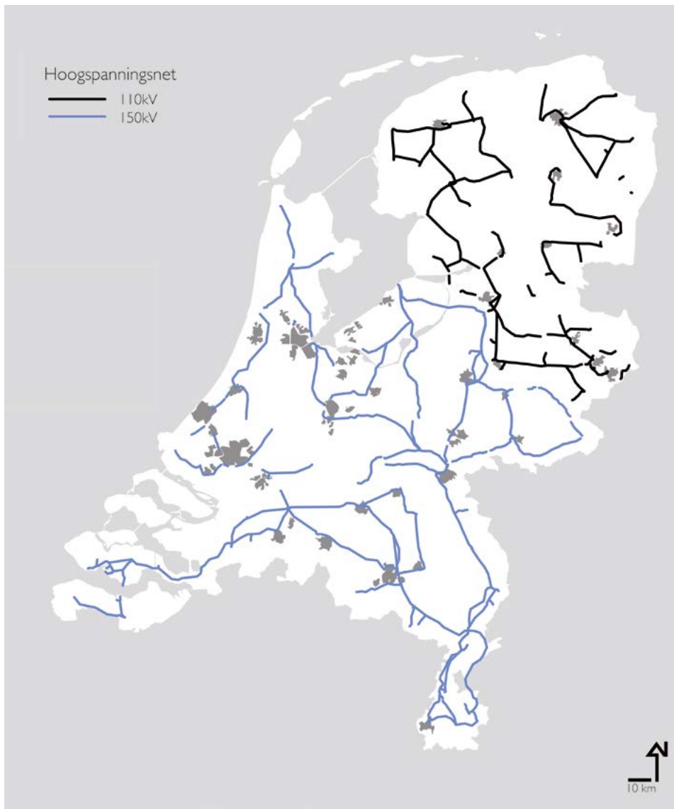
Figuur 4. Hoogspanningsnet Nederland 110 kV en 150 kV in 2016
