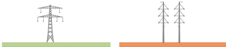
Figuur 66c. Als een 2 x 380 kV-vakwerkverbinding wordt vervangen door een Wintrack 4 x 380 kV-verbinding: forser
