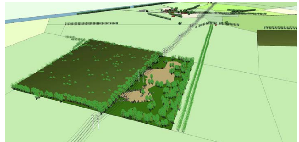
Figuur 54b. Bij de doorsnijding van een bos kan een deel van het bos worden omgevormd tot een half open natuurlijk landschap waardoor de hoogspanningslijn op een meer logische plaats in het landschap komt
