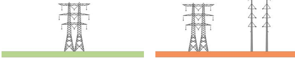
Figuur 66e. Als een 3 x 380 kV-vakwerkverbinding wordt gebundeld met Wintrack 2 x 150 kV + 2 x 380 kV: veel forser
