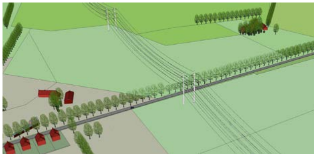
Figuur 53b. Onderbreking van een laanbeplanting bij kruising van een hoogspanningsverbinding. De lijn kruist de laan vlak bij een mast, onder de lijn kunnen de bomen blijven gehandhaafd maar moeten worden gesnoeid
