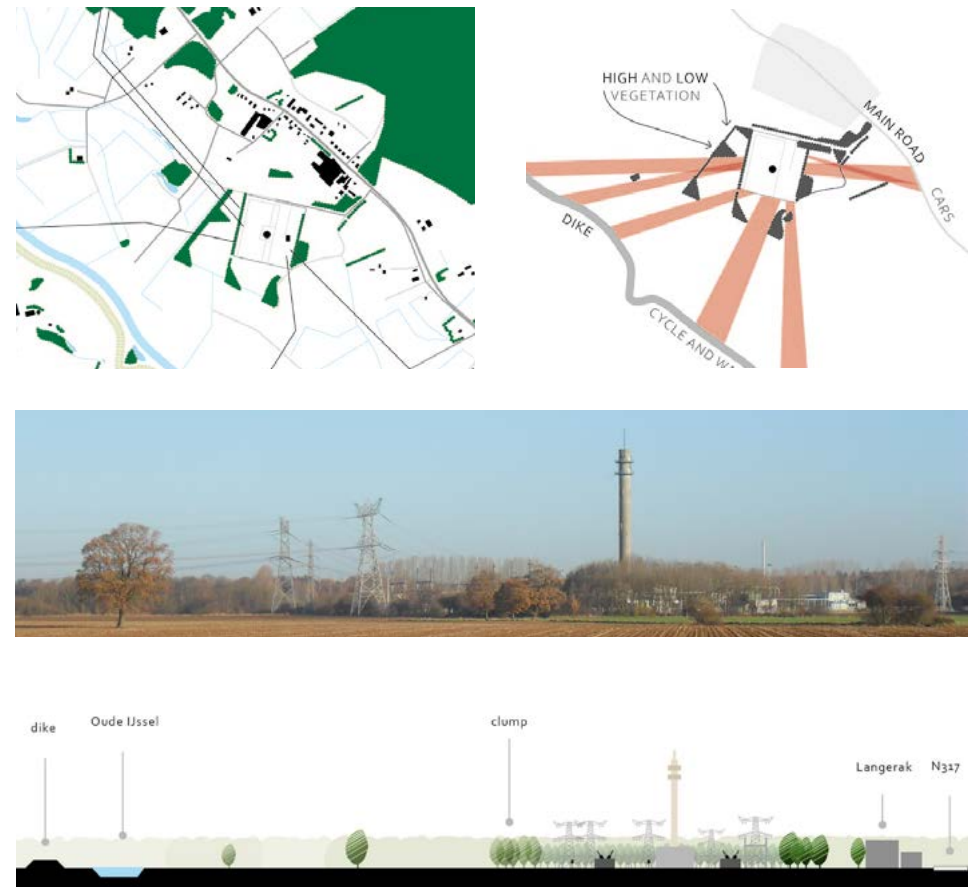
Figuur 57. Inpassing station Doetinchem-Langerak Het 380/150 kV-station Doetinchem is een goed voorbeeld van landschappelijke inpassing. Rond het station zijn zorgvuldig, passend bij de gebiedskarakteristiek, een aantal boomgroepen en houtwallen gesitueerd. Het station blijft vanuit verschillende locaties zichtbaar waardoor het geheel systeem van lijnen en station begrijpelijk blijft
