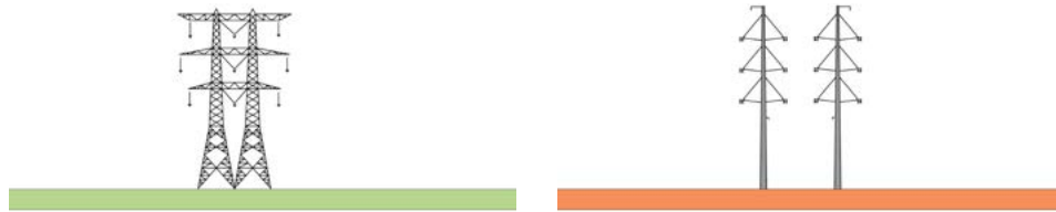
Figuur 66. Overzicht masttypen in verschillende bundelingssituaties en het relatieve ruimtelijk effect
