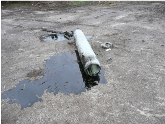
Abbildung 14: 220 kV VPE-Erdkabelfehler in Berlin-Adlershof (2008)
